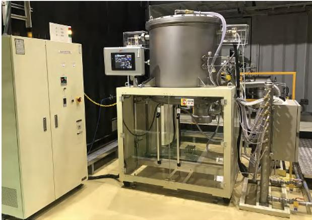
真空熱処理装置E288は、縦型上下部蓋開閉のチャンバーを有し、炉内にモリブデンヒーターを周上に配置して真空排気を行いながら昇温を行い、高温真空中において、設置された試料の熱処理を行う装置です。雰囲気温度は、温度プログラムによって管理され、安定した温度雰囲気での熱処理を行うことができます。最高到達温度は1200℃、常用温度は1150℃です。
