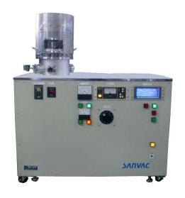
高真空蒸着装置RD-1300は小型蒸着装置の水晶振動式膜厚計搭載型抵抗加熱蒸着装置です。研究機構向けに開発された本装置は、抵抗加熱機構2対(切替式)を装備し、真空状態のまま多層膜が可能です。また排気系は、ターボ分子ポンプを採用しておりますので、短時間でクリーンな排気が可能です。
