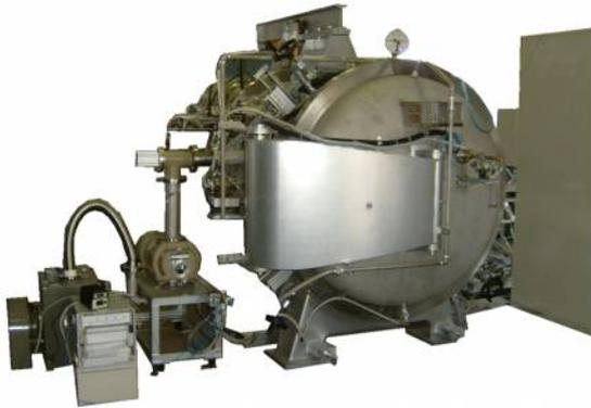
本装置はCu板ロール状のワークを真空乾燥及び焼鈍する為の装置です。
